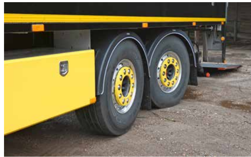
De achterste as van de oplegger is gestuurd, waardoor Jan ook op krappere plekken kan komen.
